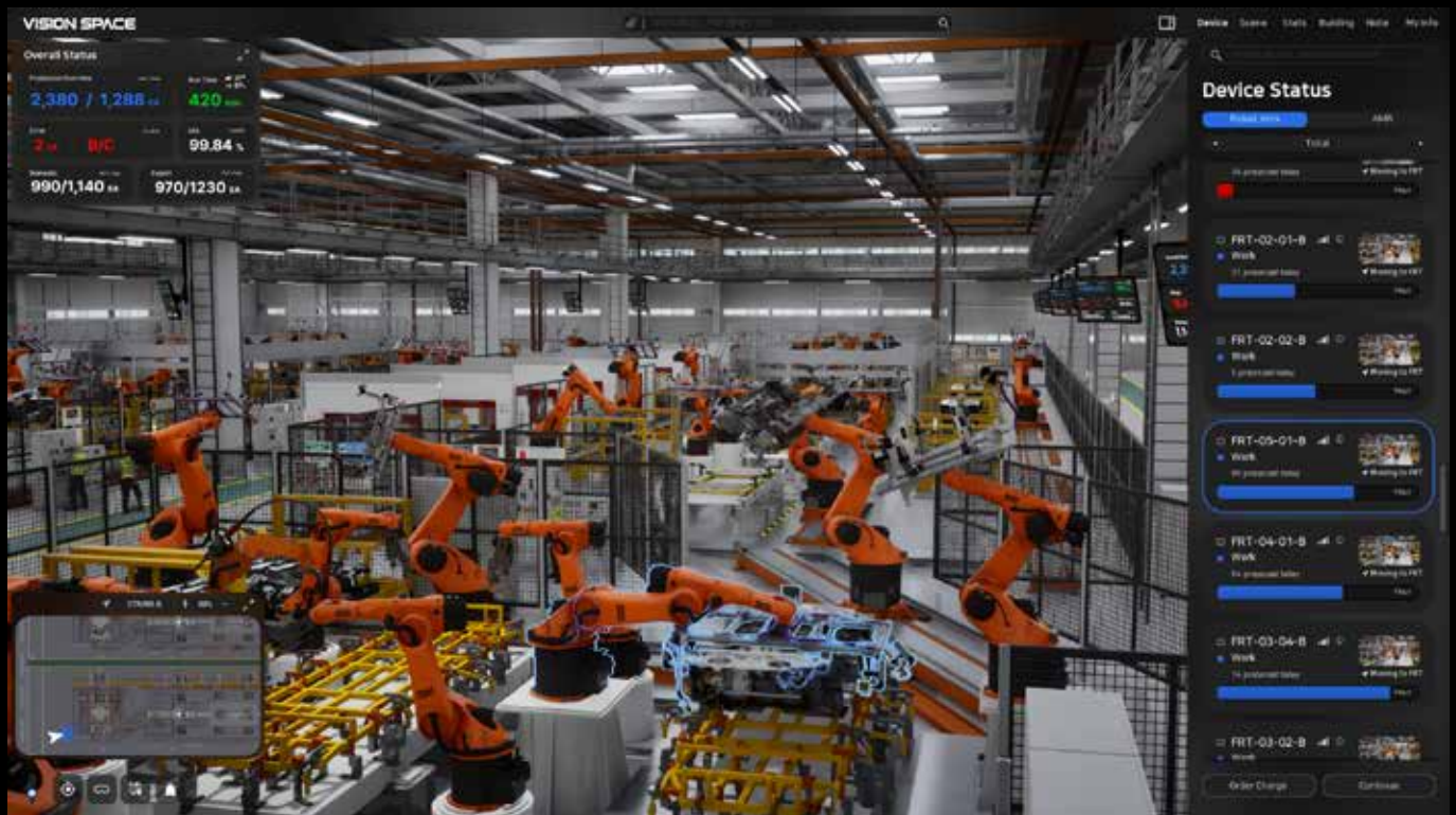
H 客户电动车车身工厂仿真与监控应用案例_占地 14,000 平方米, 集成 96 台机器人
